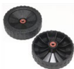
TOČKOVI Ø 185 mm Šifra: 18016 Prečnik rupe: 12 mm Dubina rupe: 39 mm Širina točkova: 43 mm Ležaj: da
